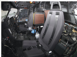
Энергопоглощающее кресло Fischer с инерционными ремнями
